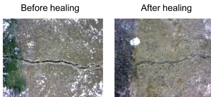
Figur 6. Verifiering av den betongsammansättning med retarderande tillsatsmedel före och efter läkning av ett fragment av sprickan.
